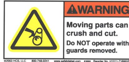
des points de pincement ou des pièces en mouvement. Assurez-vous que l'alimentation électrique est déconnectée avant de retirer toute protection et/ou panneau.
