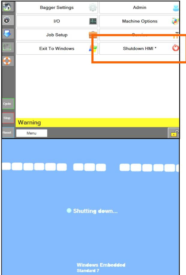
2. **IMPORTANT! ALLOW THE HMI/PC TO POWER DOWN COMPLETELY BEFORE CONTINUING TO NEXT STEP.**
