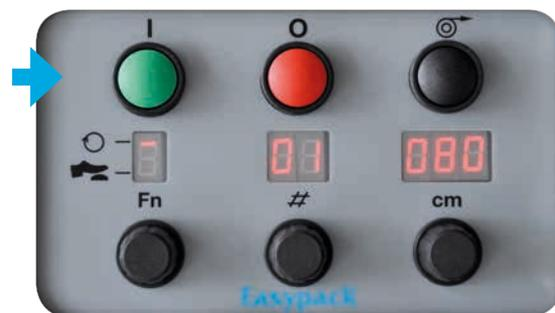
4. Appuyer sur le bouton vert de mise en marche pour activer la machine. L'écran va s'allumer. Si l'écran clignote et affiche des « tirets » cela signifie que la machine doit être chargée avec un rouleau de papier.
